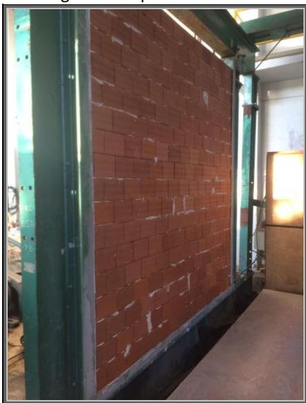
**Figura 7 – Detalhe aplicação de revestimento 1ª demão**
